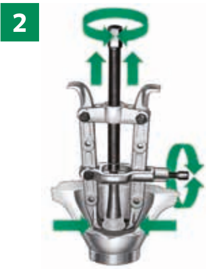
2 Funktionsprinzip eines zweiarmigen Abziehers
