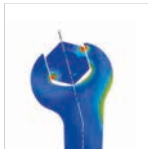
2 Belastungszonen bei Schraubenschlüsseln von STAHLWILLE
