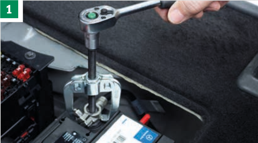
1 Polklemmenabzieher im Einsatz an einer Autobatterie
