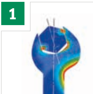
1 Belastungszonen bei handels-üblichen Schraubenschlüsseln
