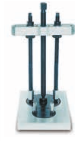
Abziehvorrichtung beim Ausbau von Zahnrädern
