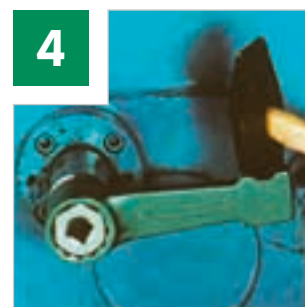
6 STAHLWILLE Schlag-Ringschlüssel Nr. 8 mit Doppelsechskant sind stärker, dünner und höher.
